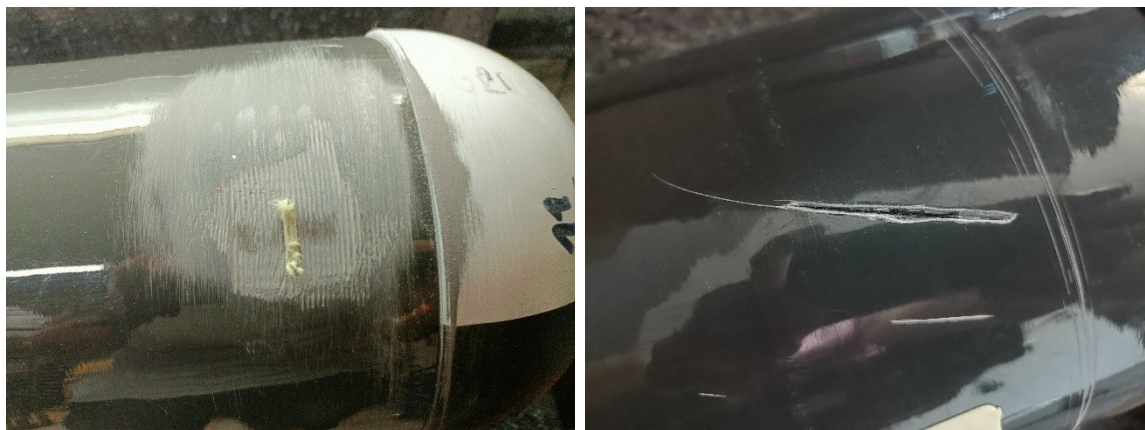
Przykładowe uszkodzenia poziomu 3 spowodowane ścieraniem lub przecięciem
