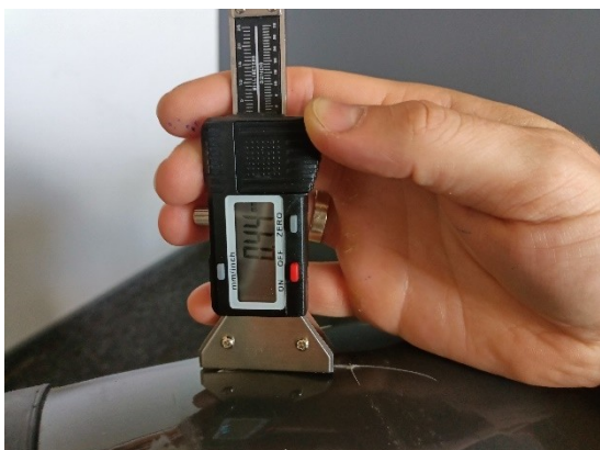
Sposób pomiaru głębokości uszkodzenia
