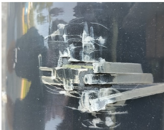
Przykładowe uszkodzenie poziomu 3 spowodowane uderzeniem
