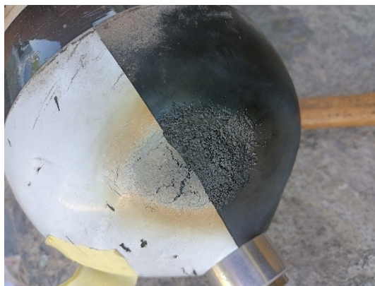
Przykładowe uszkodzenie poziomu 2 spowodowane wysoką temperaturą lub pożarem
