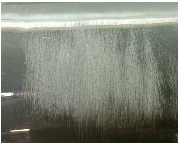
Przykładowe uszkodzenia poziomu 1 spowodowane zarysowaniem, przecięciem lub pęknięciem.
