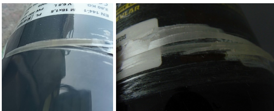
Przykładowe uszkodzenie poziomu 2 spowodowane delaminacją włókien powłoki zewnętrznej
