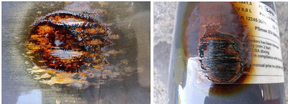
Przykładowe uszkodzenie poziomu 3 spowodowane wysoką temperaturą lub pożarem
