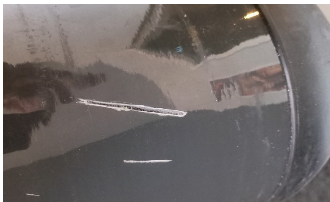
Przykładowe uszkodzenie poziomu 2 (przecięte)
