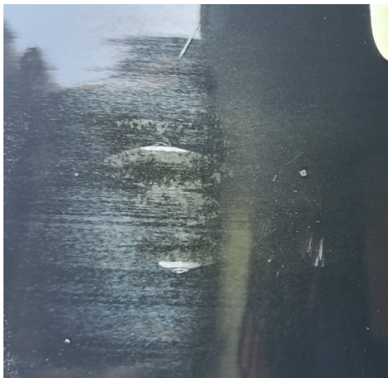
Przykładowe uszkodzenie poziomu 1 spowodowane uderzeniem
